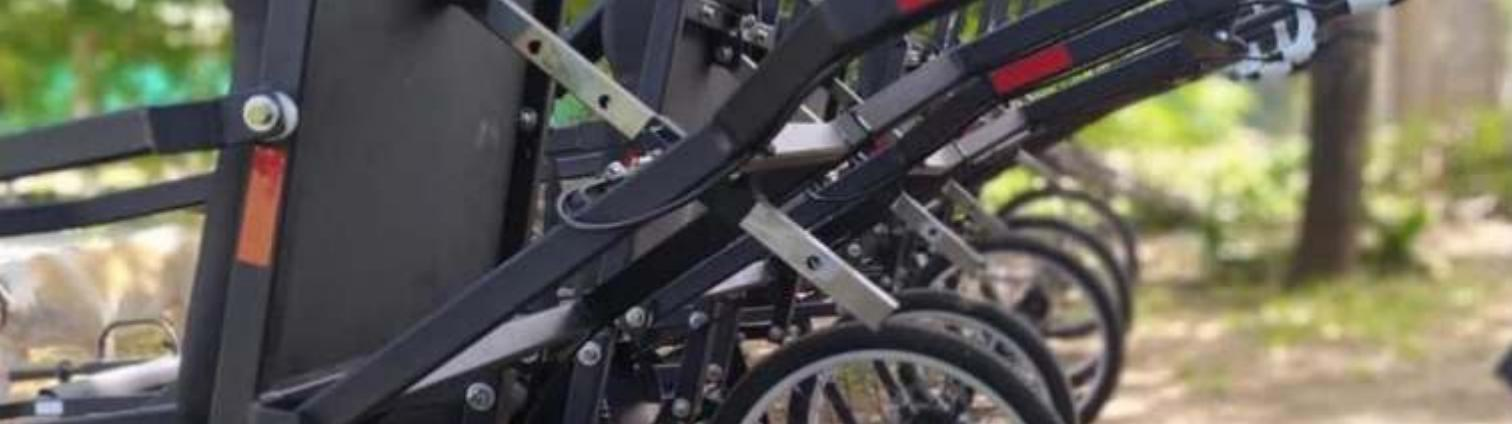
Está realizada en hierro estructural, tiene un largo de 1,70 mts., un peso de 40kgs. y soporta un peso máximo de 100kgs. La misma posee apoya pies, cinturón de seguridad y debe ser utilizada con casco. Debe ser portada por un mínimo de dos personas, recomendando siempre cuatro personas, número que varía según las características del terreno a recorrer y la extensión del mismo.
